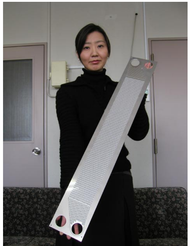
写真2 20 kW の熱交換器用プレート
