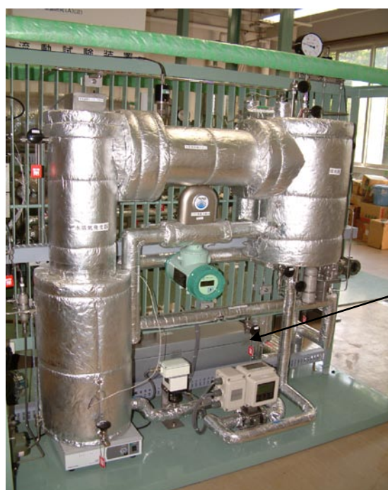
写真4 エコキュート用超臨界CO 2 ・水間伝熱流動試験装置(東工大)
