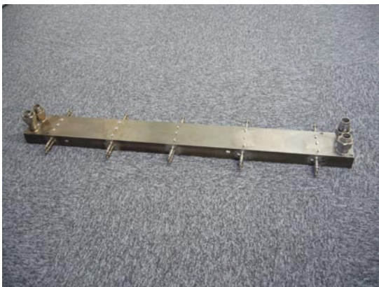
写真1 3 kWの新型熱交換器全体写真
