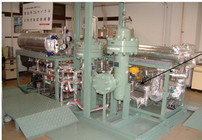
写真3 再生熱交換器用ガス・ガス間伝熱流動試験装置(東工大)
